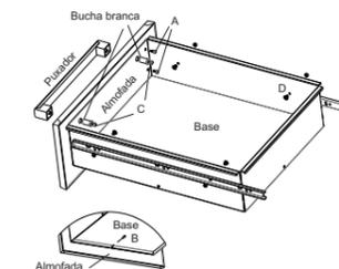
3) Fixe os parafusos A (3,9x9,5) na almofada, travando a gaveta. Utilize o parafuso B (3,9x9,5) para fixar a base na almofada. Encaixe a bucha branca e os parafusos C (3,9x9,5) juntos, no furo da almofada. Posicione o puxador e aperte os parafusos. Posicione o trilho menor, alinhando-o sobre os furos da lateral do gavetão. Utilize os parafusos D (M4x6) e as porcas M4 para fixar.
