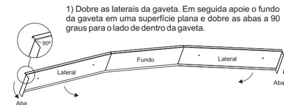
1) Dobre as laterais da gaveta. Em seguida apoie o fundo da gaveta em uma superfície plana e dobre as abas a 90 graus para o lado de dentro da gaveta.
