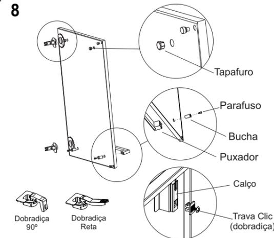
Coloque as travas clic nos calços das dobradiças. Encaixe as dobradiças nas portas (as dobradiças retas devem ser encaixadas na porta que será fixada na lateral e as de 90° na porta do meio). Coloque as buchas plásticas nos furos da parte interna das portas e passe os parafusos 3,5x8mm para fixar os puxadores. Repita esse processo para fixar os puxadores das gavetas.
